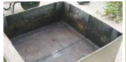
8. Faccia superiore di DEFEND ANTIRADICE/H dopo il test
