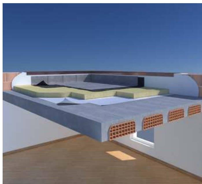
Copertura piana formata da struttura in latero-cemento, isolata con pannello in lana di roccia DDP-RT , ad alta densità, impermeabilizzata esternamente con sovrapposizione di membrana bituminosa e strato finale con rivestimento di tipo minerale.
